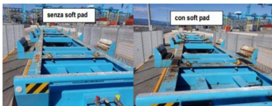
Figura 13 Esempio di tecnologie per la riduzione del rumore "soft-pad"
