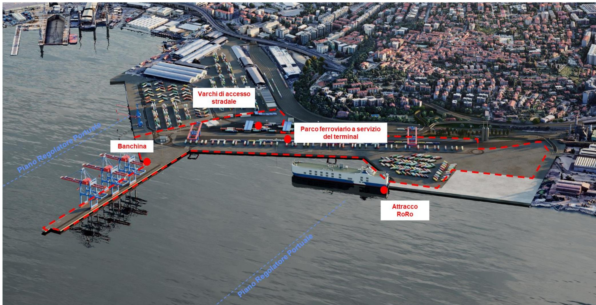
*Figura 11: Inquadramento generale delle opere principali del progetto*
